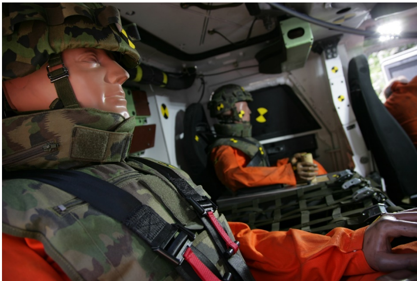
Abbildung 18: Experimentelle Charakterisierung der Schutzeigenschaften einer instrumentierten Testplattform durch Ansprenge. Die Versuchsparameter basieren auf realistischen Szenarien.
